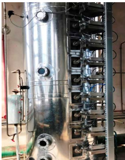
Рис. 1. Експериментальна ректифікаційна колона циклічної дії
