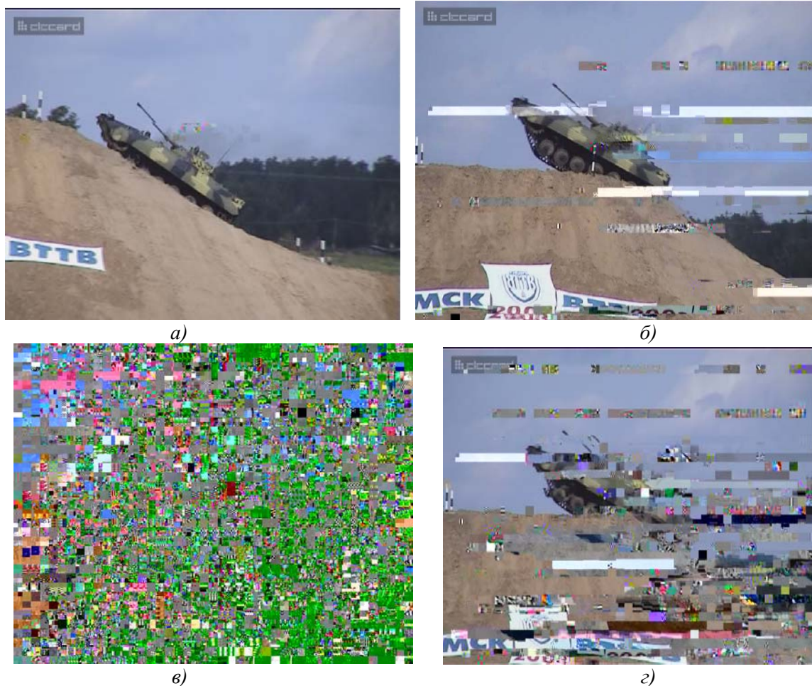
Рисунок 10 – Кадри відеопослідовності на виході відеодекодера MPEG : SSIM = 0,99, PLR = 0,003 % (а); SSIM = 0,57, PLR = 0,4 % (б); SSIM = 0,44, PLR = 12 % (в); SSIM = 0,18, PLR = 47 % (г)
