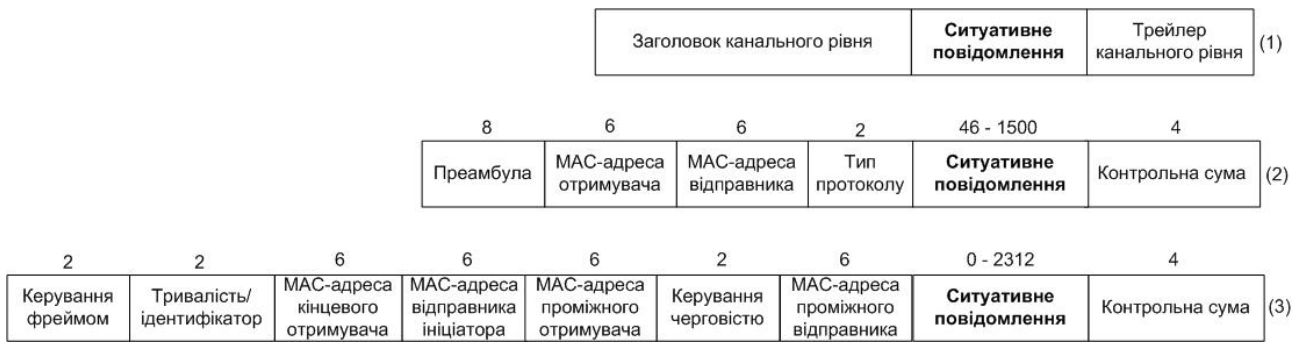
Рисунок 1 – Інкапсуляція ситуативного повідомлення в кадр каналного рівня:
