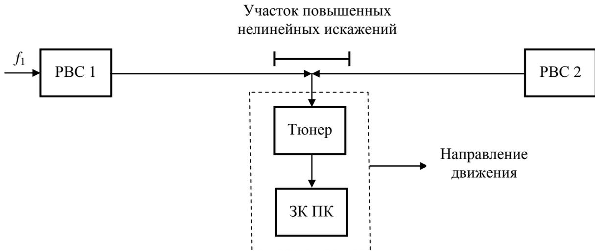
Рисунок 1 – Структурная схема размещения оборудования для реализации способа определения границ зоны синхронного стереофонического радиовещания с повышенными нелинейными искажениями
