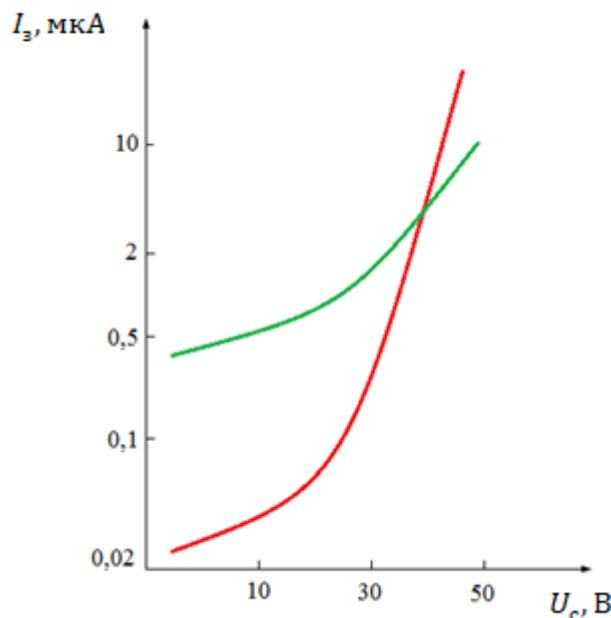
Рисунок 2 – Зависимость токов затвора от напряжения на стоке:
