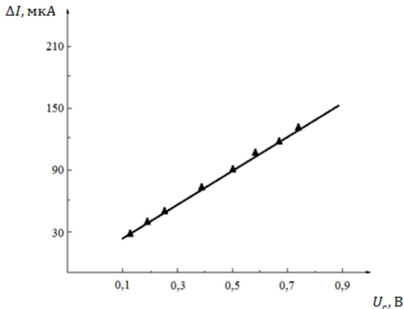
Рисунок 3 – Зависимость фототока от напряжения смещения
