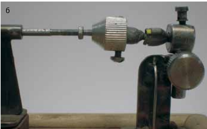
Мал. 3. Загальний вигляд пари тертя (а), робочого вузла (б) та установки (в)
