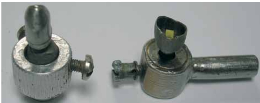
Мал.1. Загальний вигляд підготовлених до випробувань первинної (зліва) та вторинної коронок і фрикційних елементів BEGO WiroFix
