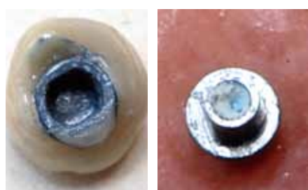
Мал. 7. Стан поверхонь коронки та опорної ділянки абатмента у зразка контрольної групи
