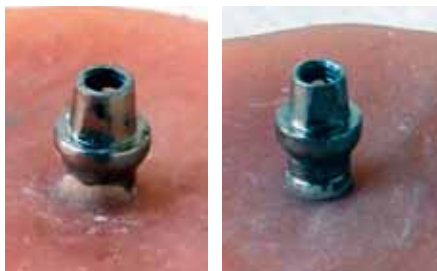
Мал. 2. Коронкоподібні абатменти, з'єднані з зафіксованою в пластмасі Протакрил коронкоподібною частиною експериментального імплантату
