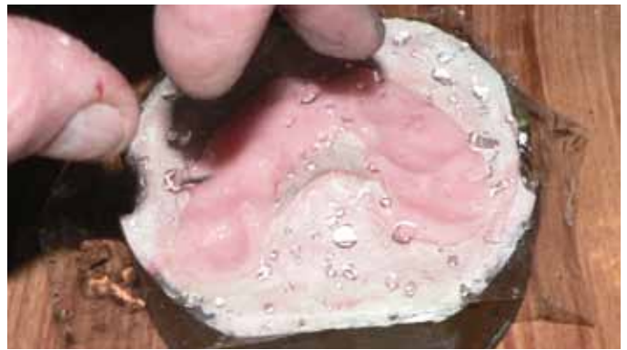
Мал. 10. Формування під пресом з поліетиленою прокладкою
