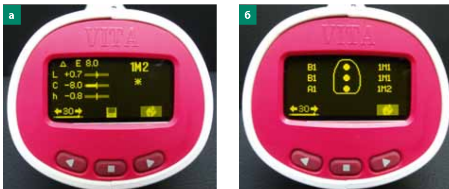
Мал. 3. Визначені координати кольору керамічної реставрації, зафіксовані приладом VITA Easychade Advance (а); дані точкового вимірювання на природному зубі (б)
