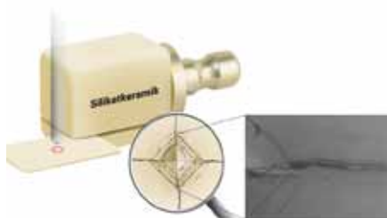
Мал. 4 а. REM-знімок: відбиток після втискання спеціальної чотиригранної пірамідки у відполіровану поверхню силікатної кераміки
