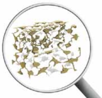
Мал. 2. Схема підсиленої полімерної сітки, що проникає в керамічну сітку
