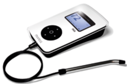
Мал. 1. Пристрій Osstell ISQ для інструментальної оцінки стабільності дентальних імплантів
