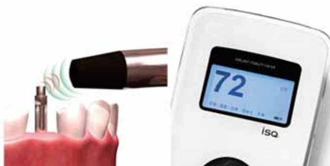
Мал. 2. Послідовність інструментального визначення стабільності дентальних імплантів за допомогою давача Smartpeg та пристрою Osstell ISQ
