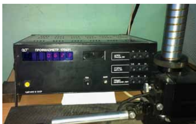
Мал. 5. Профілометр моделі 170621 («АСМА-Прибор», Росія) для визначення шорсткості поверхні
