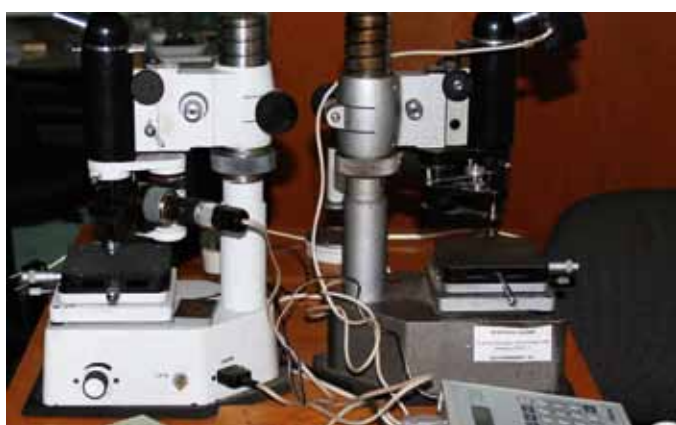
Мал. 4. Мікротвердомір ПМТ-3М («Ломо», Росія) для вимірювання мікротвердості досліджуваних матеріалів
