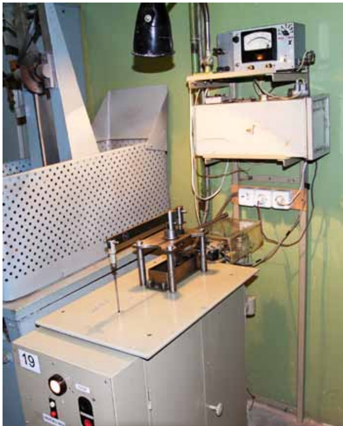
Мал. 1. Установка для дослідження матеріалів під час тертя-ковзання
