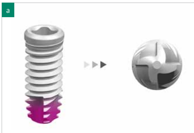
Мал. 10. а — апекс коротких та екстра-коротких імплантів, леза зменшені, згладжені, остеointegraційна поверхня збільшена. Обов'язково використовувати свердло з ріжучою голівкою для оптимізації висоти, оскільки такі свердла згладжені для максимальної безпеки під час свердління, що дозволяє обійтися без обмежувачів, які є складнішими в роботі та неточними. Рівень торку при встановленні не повинен перевищувати 40–50 Н/см; б — традиційний апекс інших імплантів з можливістю просування/свердління; при встановленні довгого імплантату у кістку щільністю 500 і 800 од. Хаунсфілда, з достатньою висотою і шириною, методика свердління не має такого значення, імплантати можна встановити навіть із рівнем торку до 70–75 Н/см, без значного ризику ішемії
