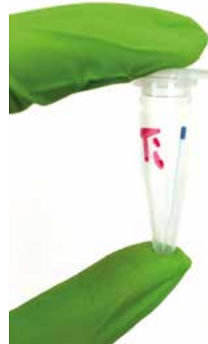
Мал. 2. Паперовий пін у пластиковій пробірці «Еппендорф»
