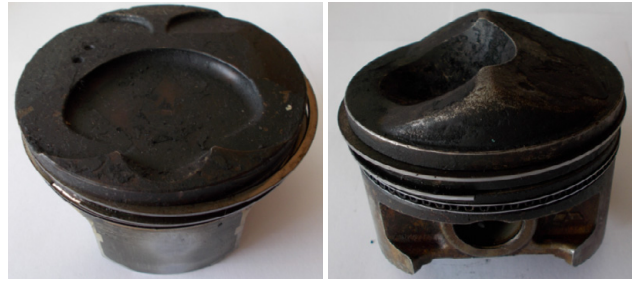
Рис. 4. Сліди поверхневих забруднень і ВТ-корозії на автомобільних поршнях
