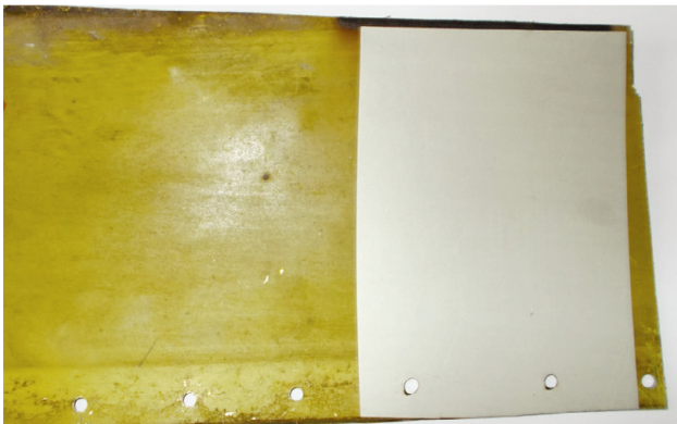
Рис. 2. Результати видалення ЛФП лазерним методом з елементів обшивки Мі-8
