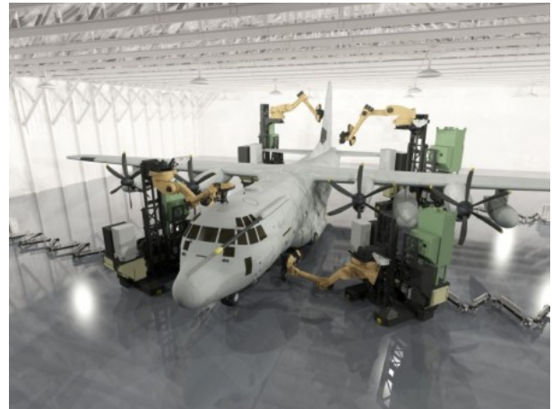
Рис. 1. Прототип автоматизованого робототехнічного комплексу з видалення ЛФП літака фірми Concurrent Technologies Corporation
