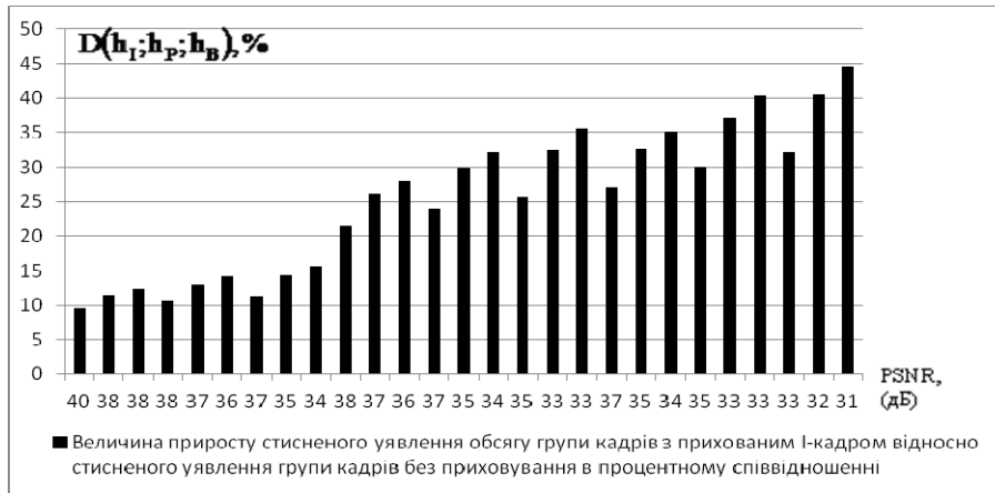
Рис. 4. Діаграма приросту D(h_I; h_P; h_B) стисненого представлення обсягу групи кадрів з прихованим I-кадром відносно стисненого представлення обсягу групи кадрів без приховування в відсотковому співвідношенні з урахуванням від середніх значень пікового відношення сигнал/шум для середньонасичених зображень
