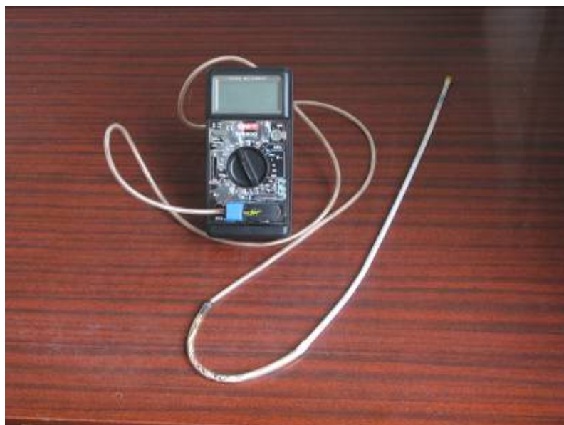
Рис. 1. Система для вимірювання малих змін вагінальної температури корів.
