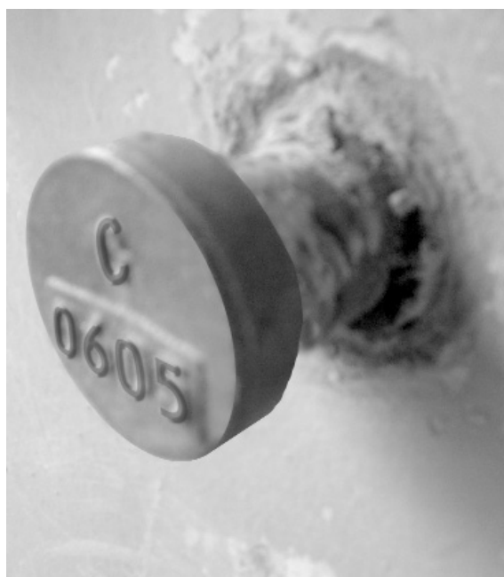
Рис. 9. Загальний вигляд встановленого репера на опорі по осі 15
