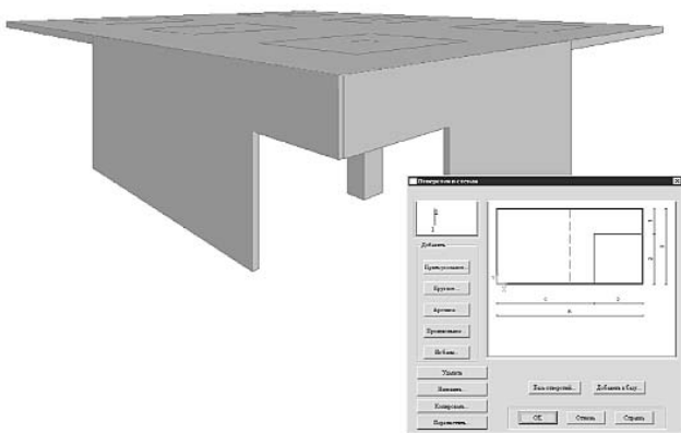
Рис. 10. Задание пересекающихся отверстий в стенах
