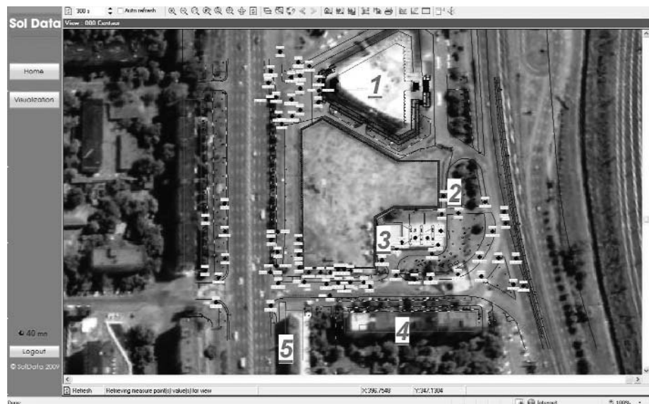
Рис. 5. Месторасположение точек наблюдения деформаций поверхности примыкающей территории, окружающей здания и коммуникации
