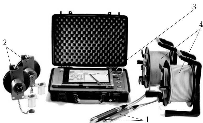
Рис. 5. Загальний вигляд ультразвукового приладу ШУМ: 1 – ультразвукові датчики; 2 – напрямні ролики датчиків; 3 – переносний комп'ютер; 4 – бухти електрокабелів від датчиків
