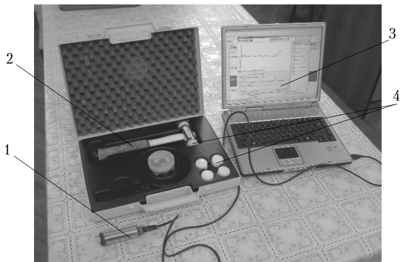
Рис. 3. Загальний вигляд акустичного приладу РЕТ під'єданого до комп'ютера:
