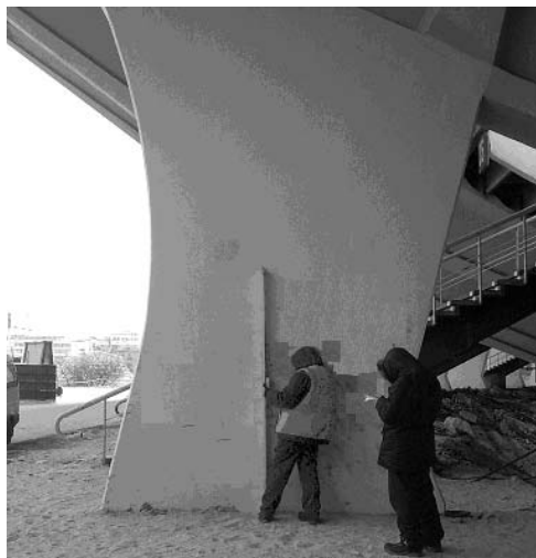
Рисунок 5. Проведення вимірювання рейкою-виском
