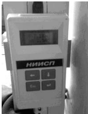
Рисунок 6. Загальний вигляд пульта управління рейки-виска
