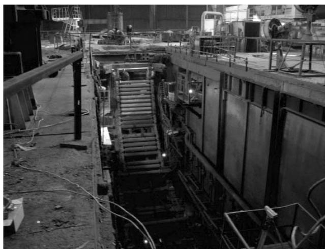
Рисунок 4. Общий вид МНЛЗ с установленными шаблонами и схема геодезических измерений
