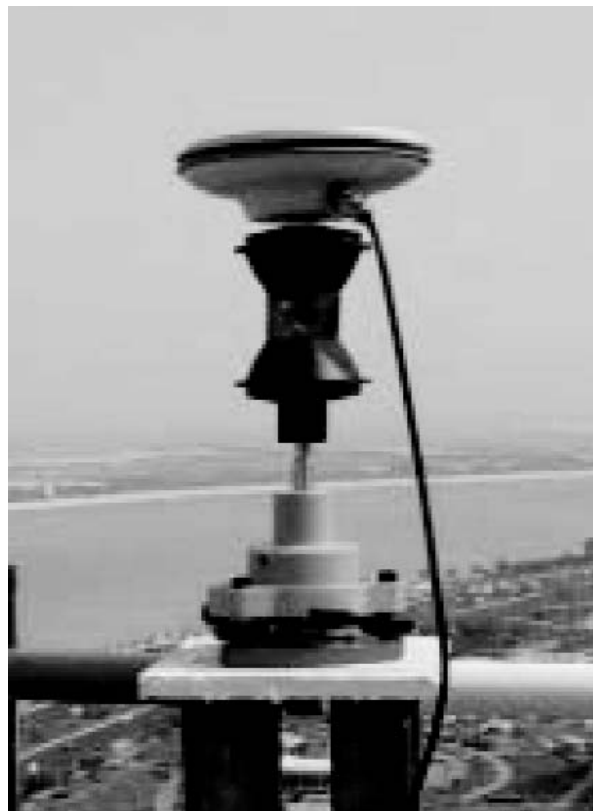
Рисунок 6. Поєднання супутникової антени з призми-відбивачами 360°
