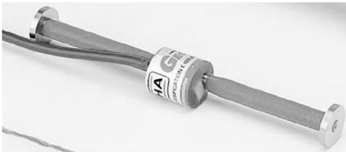
Рис. 2. Загальний вигляд датчика Geokon 4200
