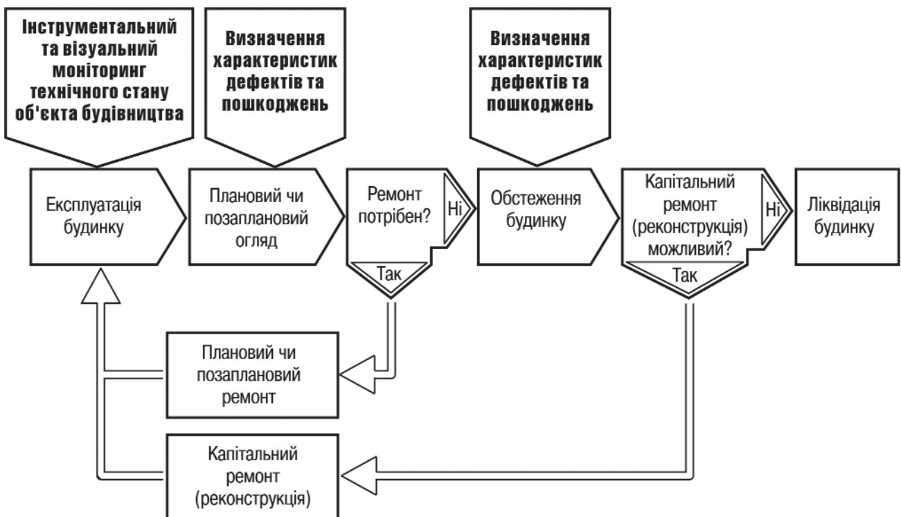
Рис. 5. Будівельно-вимірвальні роботи в період експлуатації об'єкта будівництва
