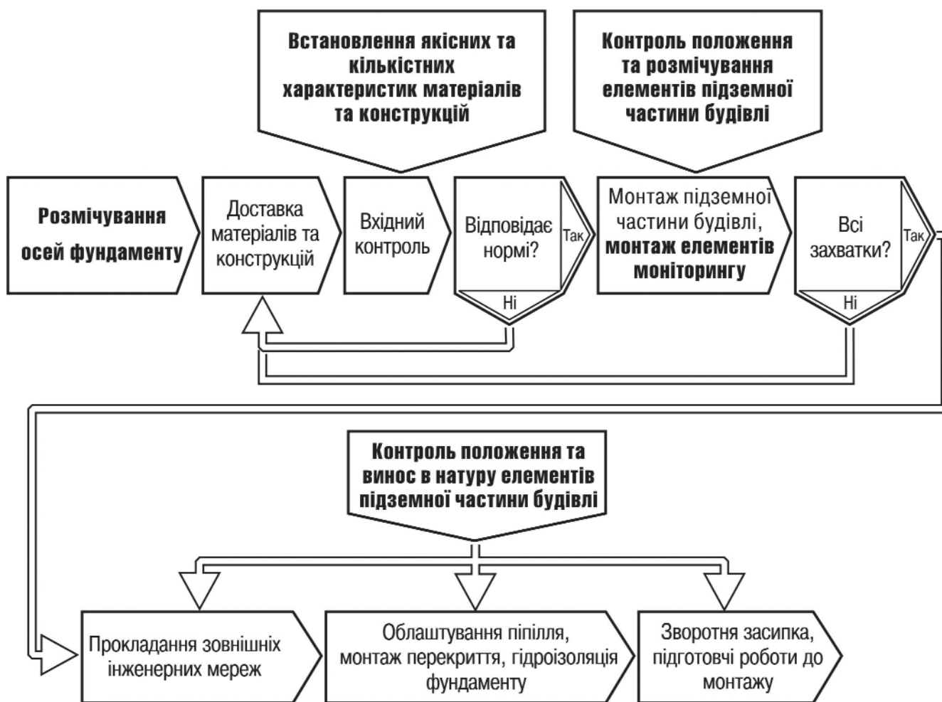
Рис. 3. Будівельно-вимірювальні роботи в період нульового циклу будівництва
