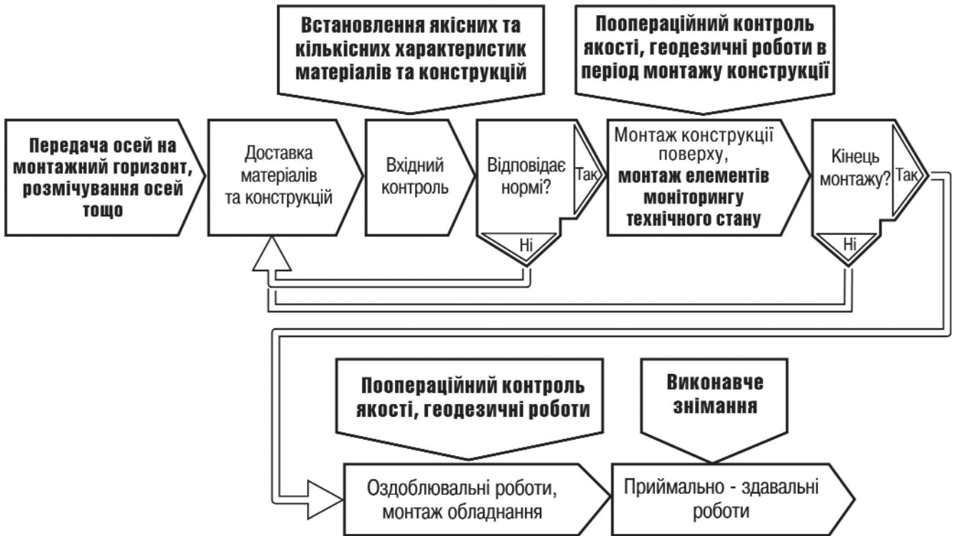
Рис. 4. Будівельно-вимірвальні роботи в період зведення об'єкта будівництва
