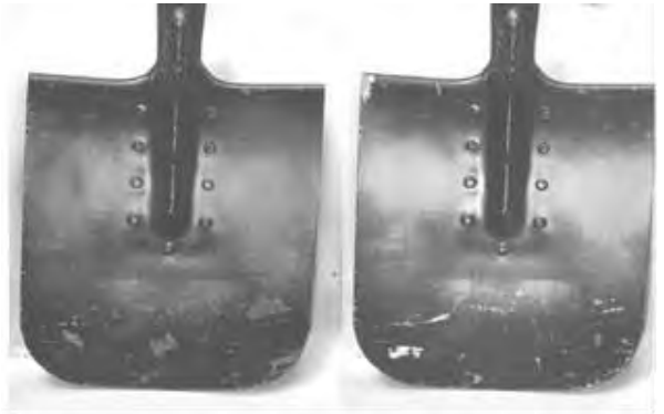
Рис. 3. Вплив корозійних і ерозійних процесів на металеве лезо: а) алюмінієве; б) сталеве
