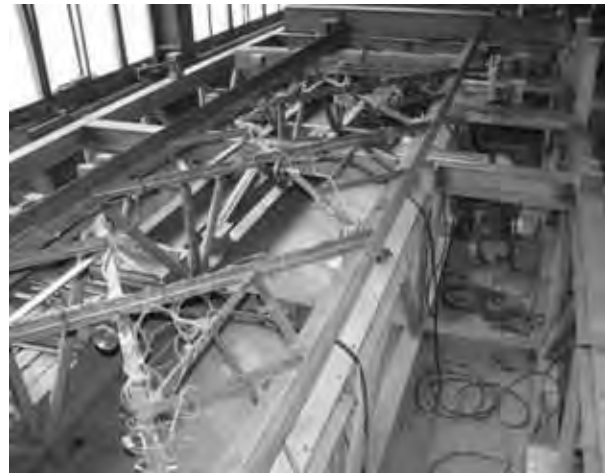
Рис. 9. Общий вид испытуемой фермы (решетка L45x4)
