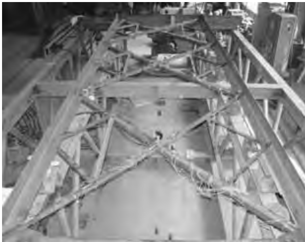
Рис. 8. Общий вид испытуемой фермы (решетка L63x5)
