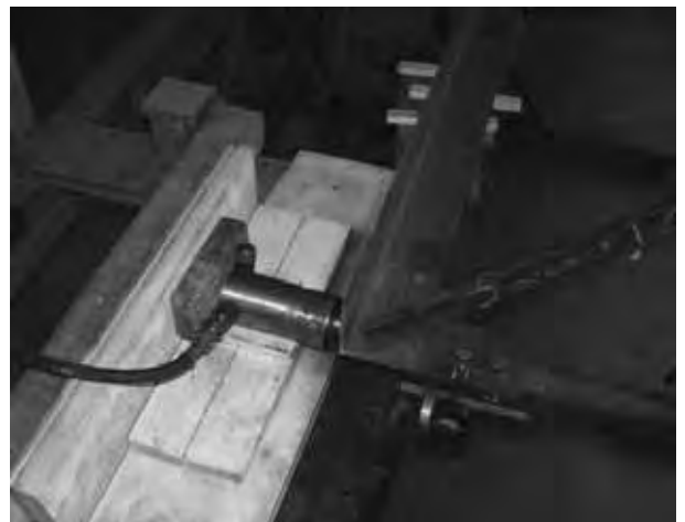
Рис. 11. Узел установки гидравлического домкрата ДГ-10
