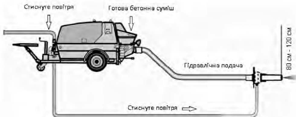
Рис. 2. Гідравлічна подача суміші при способі мокрого торкретування
