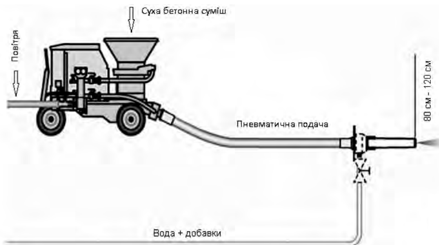
Рис. 1. Пневматична подача дрібнозернистої бетонної суміші при способі сухого торкретування
