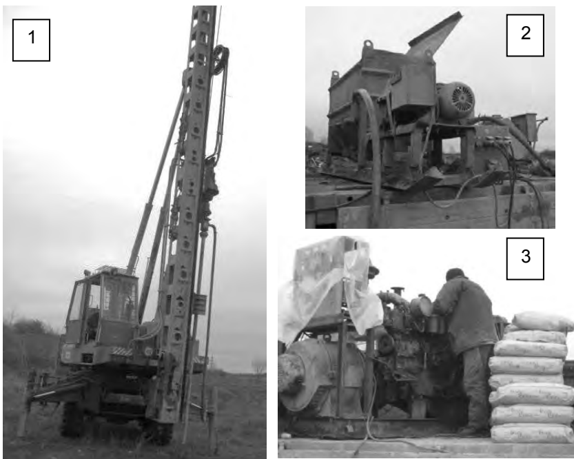
Рис. 1. Комплект обладнання для влаштування ґрунтоцементних елементів за бурозмішувальною технологією
