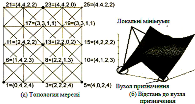
Рис. 1. Приклад «поганого» розподілу опорних вузлів
