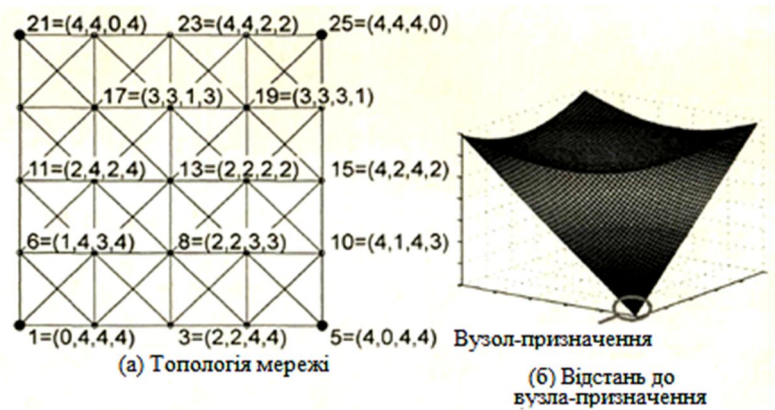
Рис. 2. Приклад «хорошого» розподілу опорних вузлів
