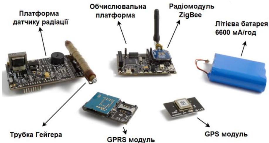
Рис. 2. Типова комплектація інтелектуального сенсорного пристрою
