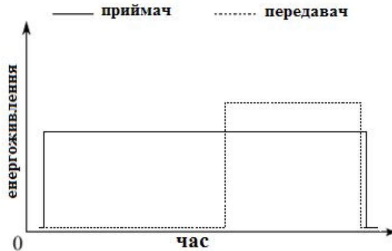
Рисунок 4.2. Неефективний сеанс зв'язку: приймаючий вузол витрачає забагато часу на очікування пакету (прослуховування ефіру)
