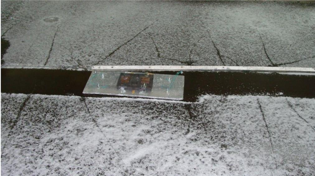
Рис. 5 Характер разрушения модельно льда  $h_m=0.003$  м после прохождении моделей массой  $m_m=2.84$  кг кильватером при  $l_m=0.94$  м с критической скоростью  $u_m=1.7$  м/с.
