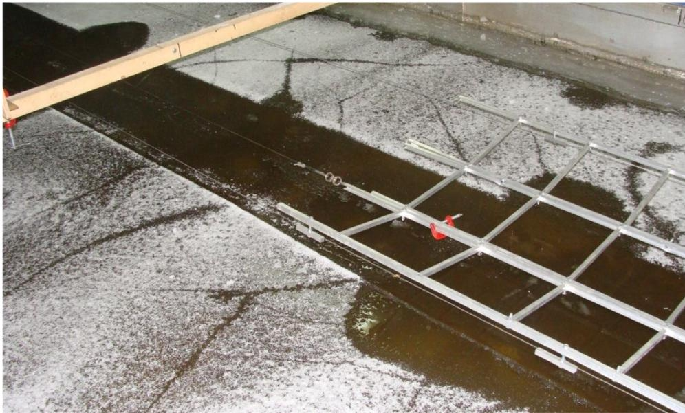
Рис. 7 Характер разрушения модельно льда  $h_m=0.003$  м после прохождения моделей массой  $m_m=2.84$  кг при полном сцеплении с  $u_m=1.9$  м/с.
