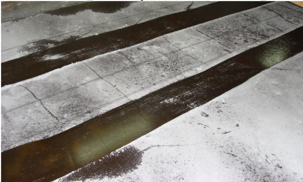
Рис. 8 Характер разрушения модельно льда  $h_m=0.003$  м после прохождения моделей СВІП массой  $m_m=2.84$  кг при расстоянии между ними 0.5 м с критической скоростью  $u_m=1.7$  м/с.
