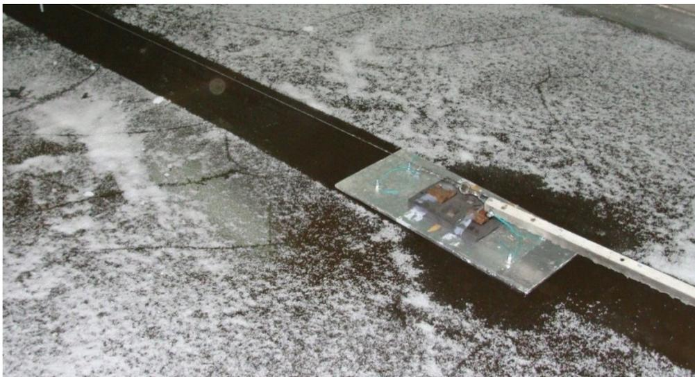
Рис. 4 Характер разрушения модельного льда  $h_m=0.003$  м после прохождения моделей массой  $m_m=2.84$  кг кильватером при  $l_m=0.745$  с критической скоростью  $u_m=1.7$  м/с.
