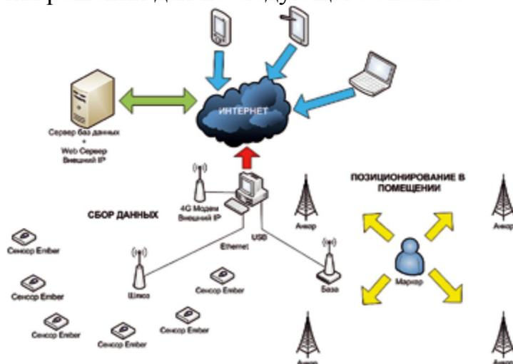
Рис. 1. Структура испытательного стенда в лаборатории Интернета Вещей
