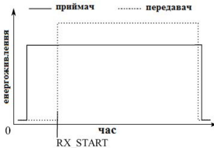
Рисунок 2. Час початку отримання пакета зберігається обробником переривання RX_START
