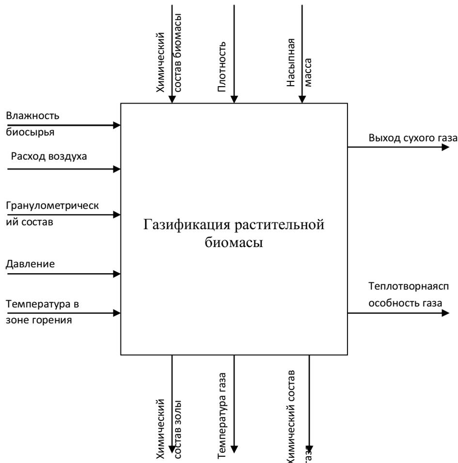
Рис. 3. Параметрическая схема подсистемы газификации растительной биомассы
