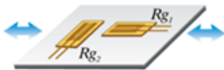
Рис. 3 - Схема наклеювання датчиків на поверхню барабана
