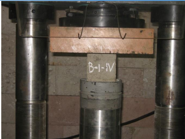
Рис. 3. Определение класса бетона.
