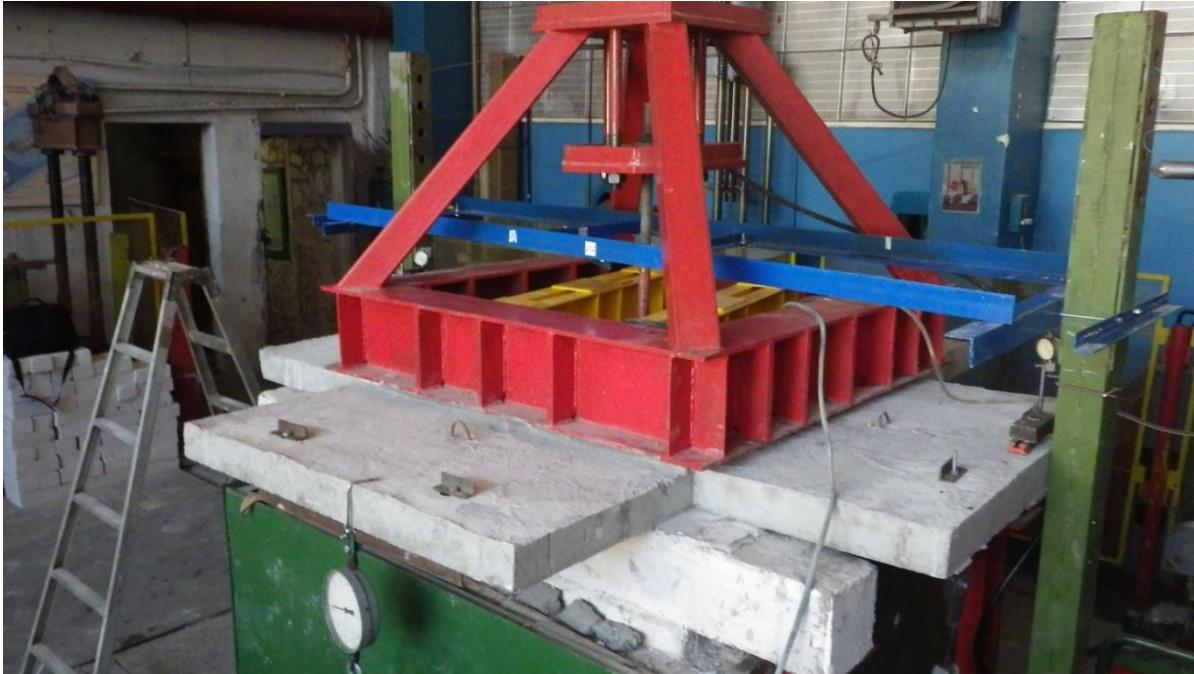
Рис.19. Общий вид испытания железобетонной плиты ПЗ с 4 консолями
