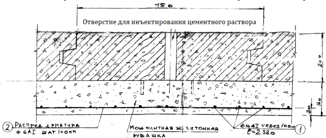
Рис. 5. Схема стыковки тюбингов с устройством внутренней армированной обделки
