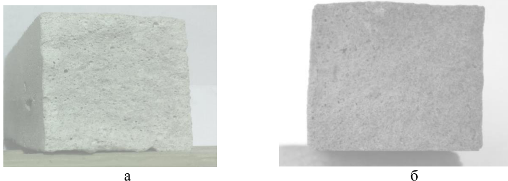
Рис.3. Степень пропитки жидким стеклом армированных стекловолокном бетонов, а – без пропитки, б –пропитан.
