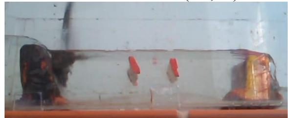
Рис. 4. Распределение примеси в отстойнике с пластинами ( $t=0,2$  с)
