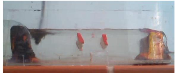
Рис. 3. Распределение примеси в отстойнике с пластинами ( $t=0,1$  с)
