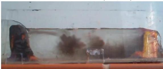
Рис. 2. Распределение примеси в отстойнике без пластин ( $t=1,2$  с)
