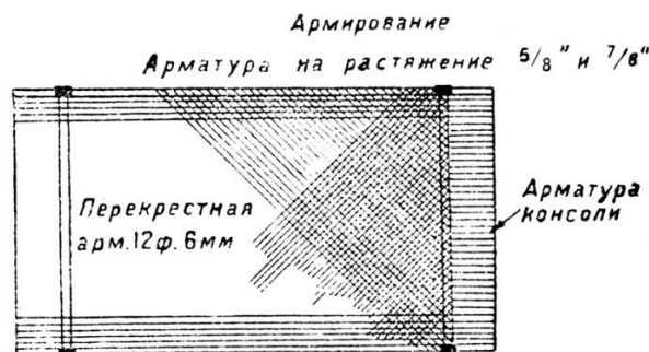
Рис. 1. Первая тонкостенная оболочка – наклонный свод в здании Харьковского почтамта. Схема, 1928.
