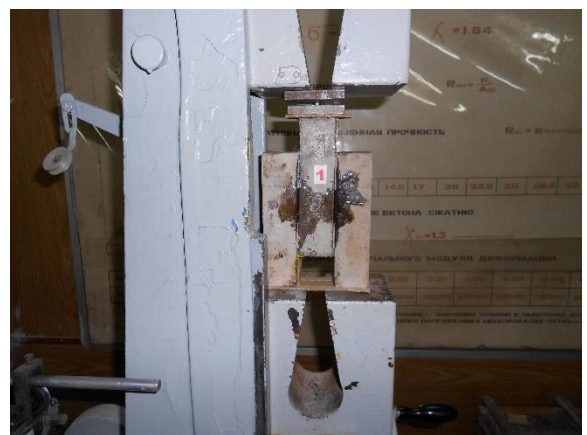
Рис. 6. Испытание на срез
