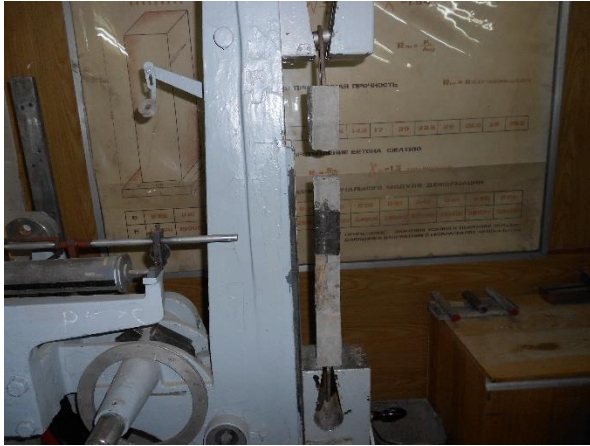
Рис. 3. Характер разрушения при растяжении склеенных бетонных восьмерок (по бетонному сечению)
