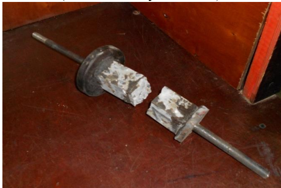
Рис. 4. Характер разрушения при растяжении склеенных бетонных призм
