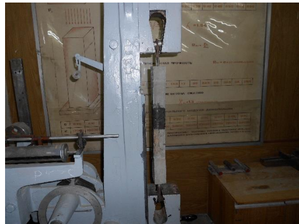
Рис. 1. Испытание склеенных по торцам бетонных восьмерок на растяжение в лаборатории ХНУСА
