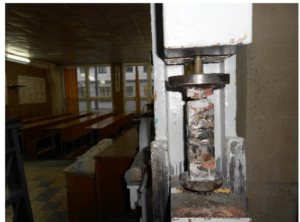
Рис. 5. Испытание повторно склеенных по торцам бетонных призм на растяжение в лаборатории ХНУСА
