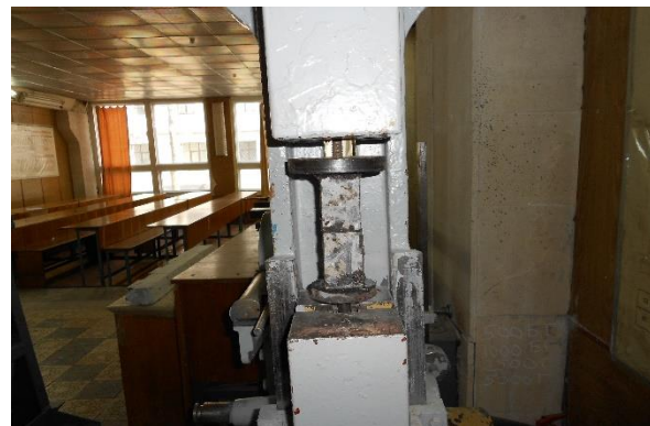
Рис. 2. Испытание склеенных по торцам бетонных призм на растяжение в лаборатории ХНУСА
