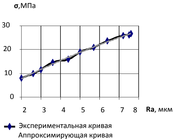
Рис. 3. Зависимость прочности сцепления напыленного покрытия с основой от шероховатости поверхности
