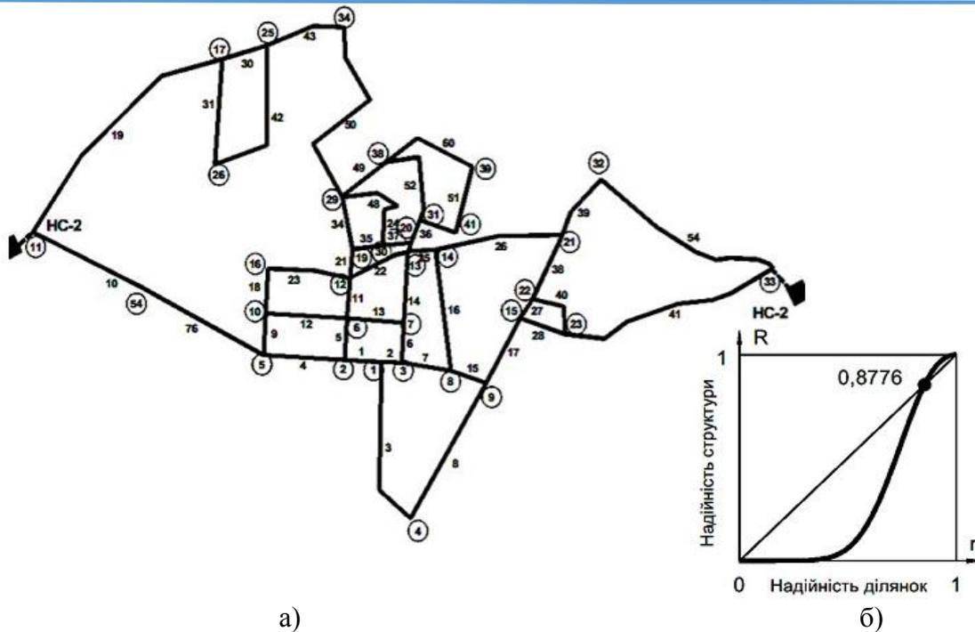
Рис. 4. Структура мережі (а) та графік функції надійності (б) для зони 2-го і 4-го водозаборів після підвищення надійності
