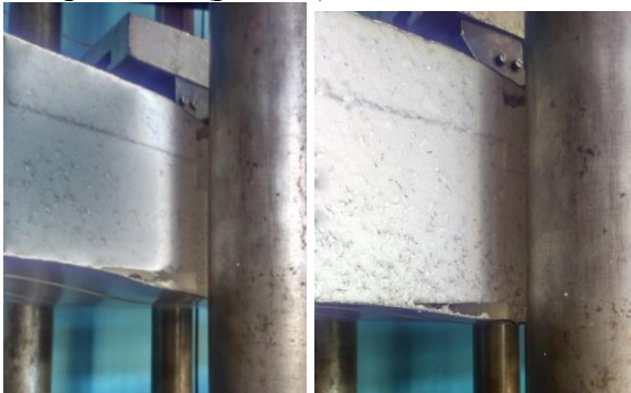
Рис. 11. Расслоение панели по поперечному стыку утеплителя
