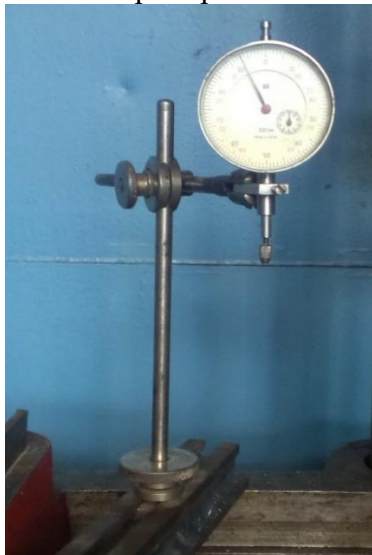
Рис. 7. Индикатор часового типа ИЧ-10
