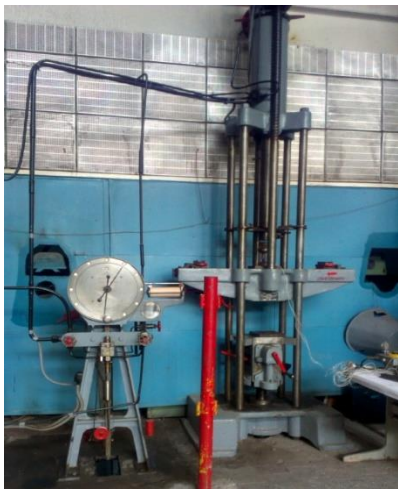
Рис. 4. Универсальная испытательная машина УИМ-50
