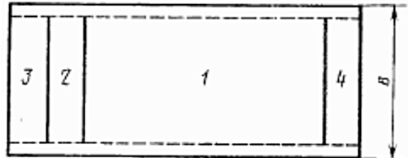
Рис. 2. Схема мест вырезки образцов панелей, где цифрой 1 обозначена часть панели для испытания ее прочности при поперечном изгибе.
