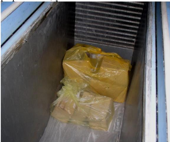
Рис.2. Выдерживание увлажненных образцов в морозильной камере
