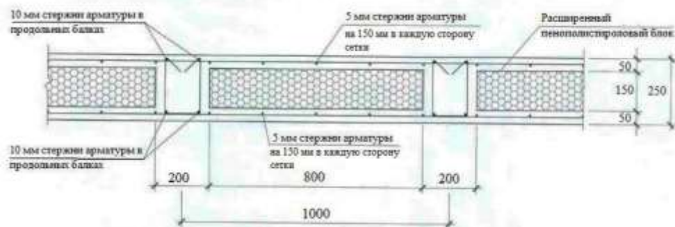
Рис. 14. Поперечное сечение перекрытий небоскреба
